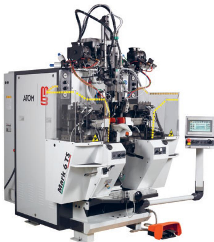
Nuova generazione di montaboette a chiodi con montafianchi a microsemenza, programmazione a video del profilo del sottopiede e contemporaneo posizionamento delle chiodatrici laterali.
