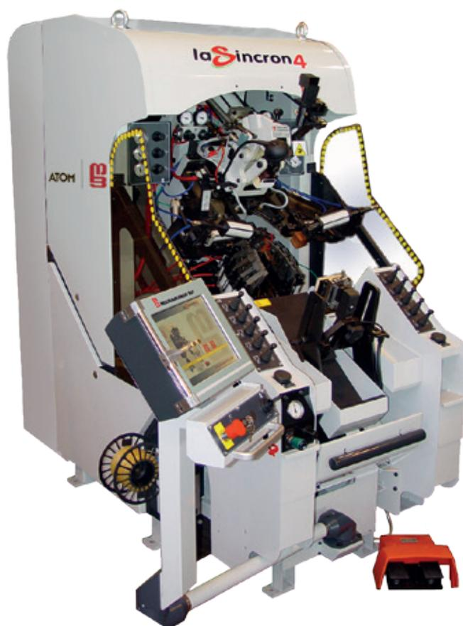
Premontatrice-Montatrice a 11 pinze a funzionamento pneumatico, controllata tramite microprocessore. Permette di utilizzare due sistemi di distribuzione della colla: con ugelli programmabili oppure corona più ugelli.
