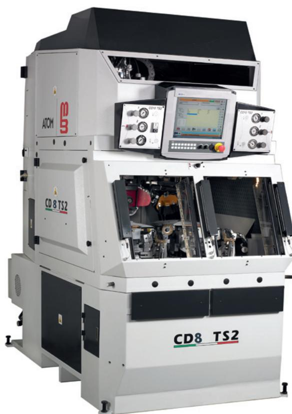
Macchina computerizzata ed automatica per la cardatura del bordo della calzatura, particolarmente adatta alle sneaker e alle produzioni di tipo strobel.
